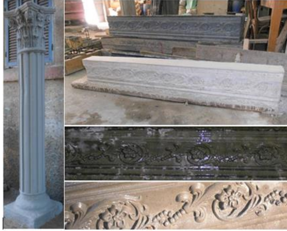
شكل (١٩ - ب) كمرتين إنشائيتين زخرفيتين من الأسمنت البورتلاندي العادي والأبيض والتي تم استخدام زخارف من نبات الأكنثس الروماني في تنفيذ الحلية المعمارية (كورنيش) شكل (١٩) العناصر المنتجة بالخرسانة ذاتية الدمك.
